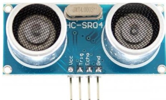
Рисунок 2 – Ультразвуковий датчик відстані HC-SR04.
