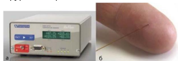
Рисунок 6 – Система вимірювання температури на основі волоконно-оптичних датчиків: а) вимірювальний пристрій; б) волоконно-оптичний датчик температури (300 мкм у діаметрі) (адаптовано із роботи [3])
