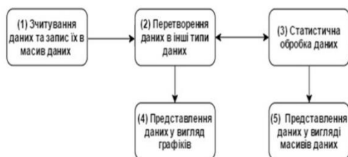
Рисунок 3 – Алгоритм роботи комп'ютерної моделі для обробки спекл-інтерферограм у дослідженні [13]
