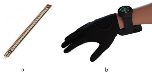
Рис. 5 – а – датчик згину, б – роботизована рукавичка
