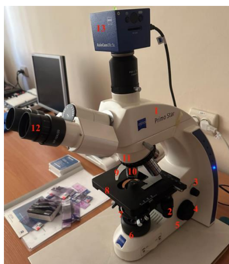
Рисунок 6 – Зовнішній вигляд електронного мікроскопа «Zeiss Primo Star»: 1 – головка мікроскопа; 2 – ручка для позиціонування предметного столика; 3 – налаштування освітленості; 4 – грубе збільшення; 5 – м'яке збільшення; 6 – освітлювач; 7 – конденсор; 8 – предметний столик; 9 – тримач зразків; 10 – лінзи; 11 – револьверна оправа; 12 – окуляр
