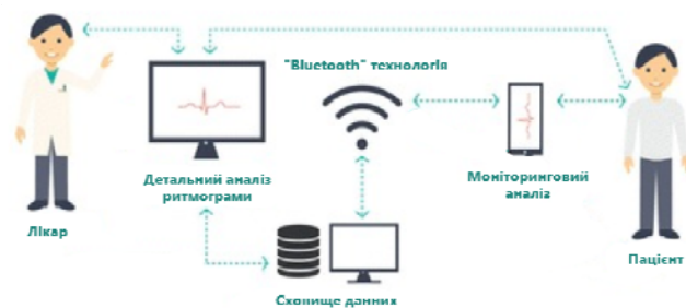
Рис. 5. Діаграма принципних компонентів апаратно-програмного комплексу для моніторингового аналізу ритмограм
