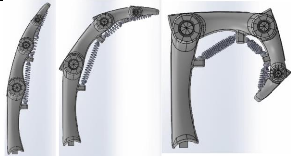
Рисунок 4 – Демонстрація рухомості прототипу пальця. Створено в середовищі SolidWorks
