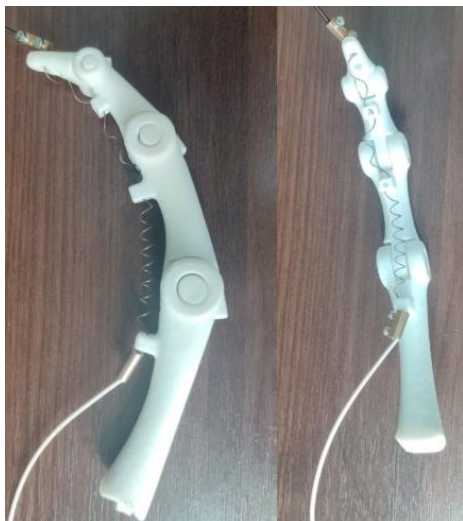
Рисунок 9 – Результат друку та кріплення штучного м'язу у вигляді нітинолової пружини
