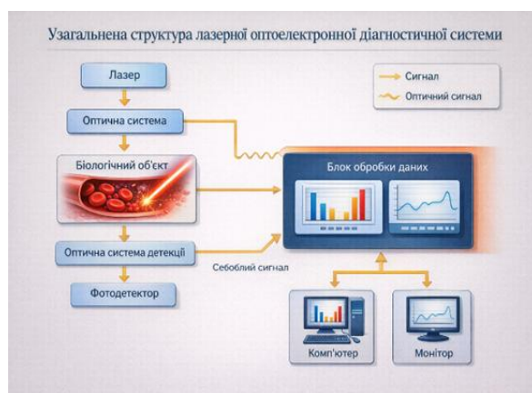
Рис. 5. – Узагальнена структура лазерної оптоелектронної діагностичної системи.
