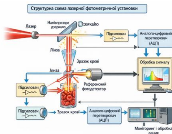
Рис. 2. – Структурна схема лазерної фотометричної установки
